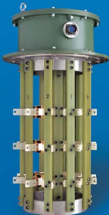
▲ 外型小，传动部件全部设计安装在头部法兰内，与下部密封隔开，具有结构简单，检修维护方便，且避免污染变压器油。
