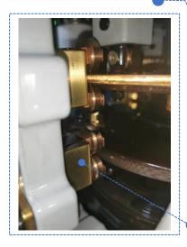
转换触头全部采用滚动设计,磨损小,铜钨材质的触头,确保在真空管因漏气或绝缘下降不能可靠熄弧时, 其在一定次数内可开断电流,从而避免级间短路。
