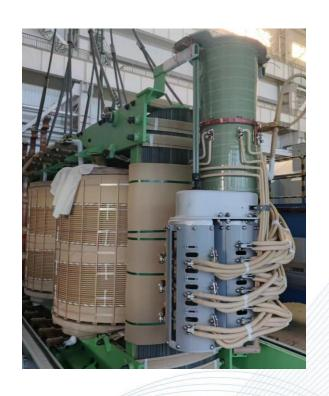
SHZV 型油浸式真空有载分接开关
