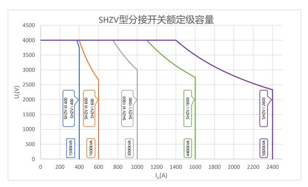
额定级容量定义为级电压与负载电流的乘积,即  $P_S=UI$ 。额定级容量是分接开关在连续工作条件下最大级容量,即  $P_{StN}=I_{ux}\times U_i$ 。
