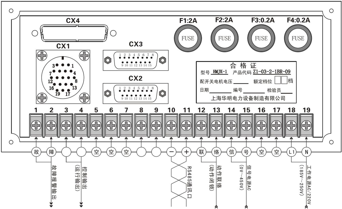
控制器CX1（19芯）航空插头与分接开关（19芯）航空插头连接接线表
